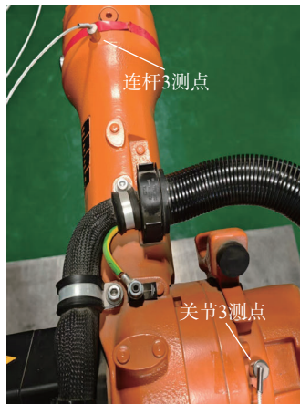
(b) 关节3及连杆3温度测点位置
